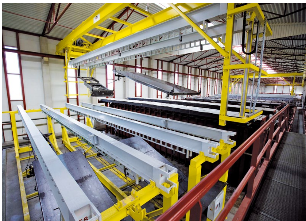
Die bis zu 16 m langen und 4 t schweren Bauteile für Anhänger durchlaufen die hochmoderne Beschichtungsanlage – von der Oberflächenvorbehandlung über die KTL-Tauchbecken bis in die Pulverbeschichtung.
