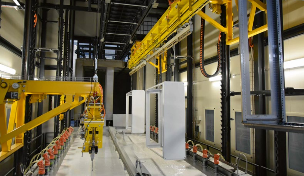
Die Schaltschrankteile werden per Epoxid-Kataphorese-Verfahren beschichtet, die Besonderheit: auch nach dem Trocknen der Pulverbeschichtung ist kaum eine Vergilbung festzustellen.
