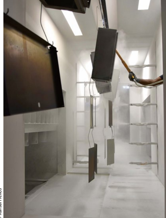
Der Pulverbeschichtungsbereich ist mit einem schnellen Farbwechselsystem und einer traditionellen Venturi-Fördereinheit ausgestattet.
