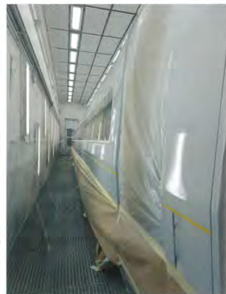
Bild 7: Grundieren der Fahrzeuge mit speziellem, wasserbasierten 2K-Polyurethan-Metallgrund
