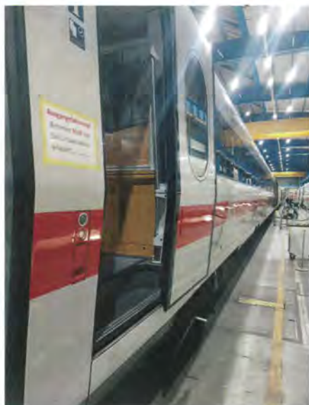
Bild 5: Neu gestaltete Außenhülle eines ICE 1-Zuges, der mit den RAL-Farbtönen 7035 und 7012 sowie dem typischen roten ICE-Streifen RAL 3020 ein modernes Design erhalten hat
