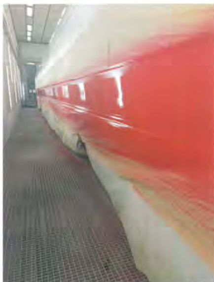
Bild 6: Anschleifen der Aluminium-Oberfläche der ICE 1-Züge in den DB-Instandhaltungswerken
